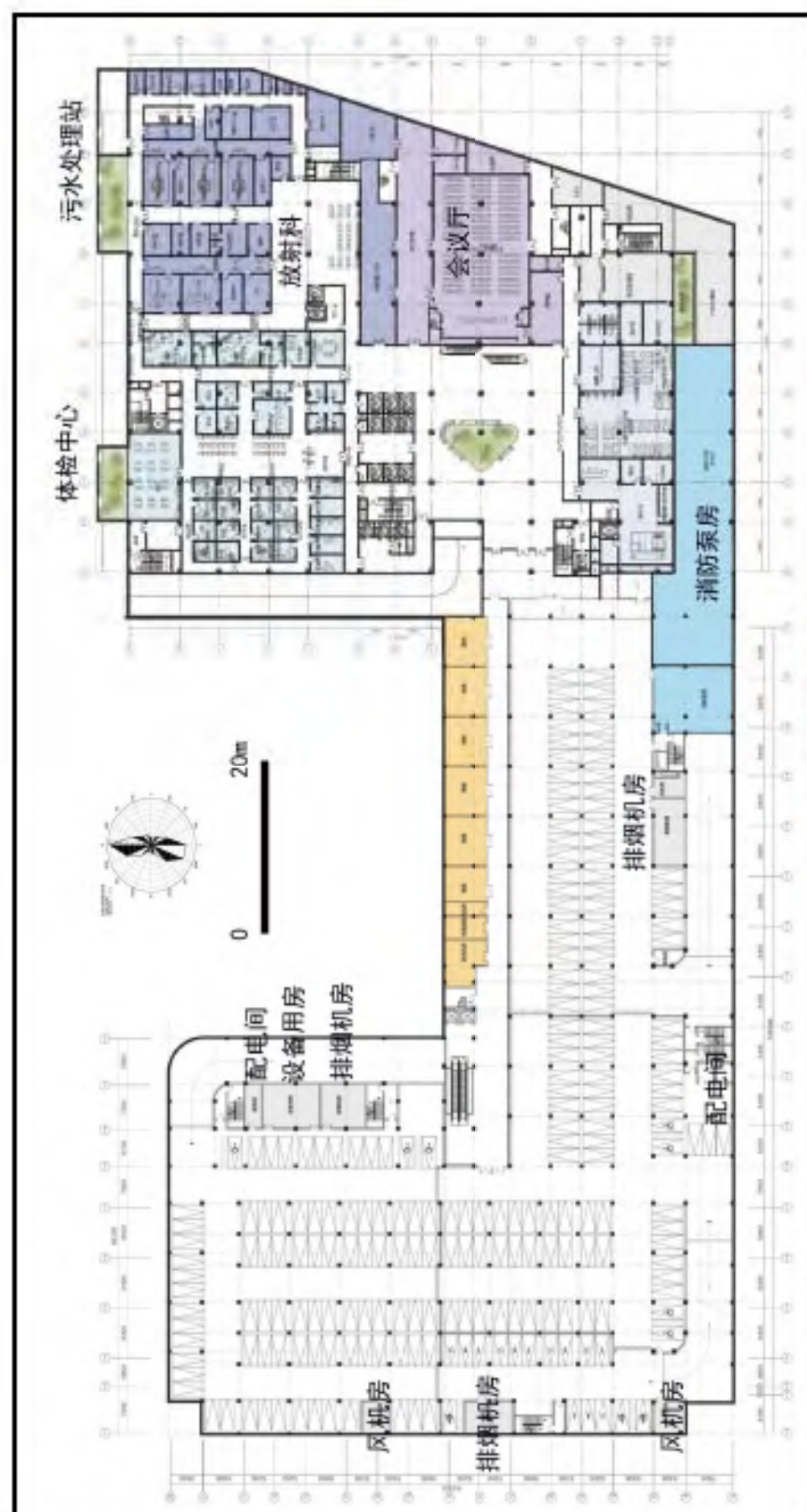
图 2.7 地下一层平面布置图
