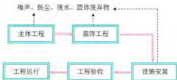
图 2.15 施工期工艺流程及产污节点图
